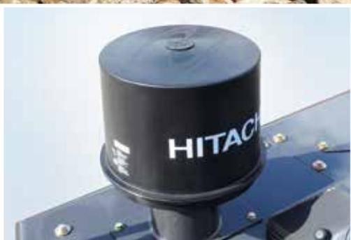
Un nettoyage réduit du filtre est possible grâce au pré-filtre à air optionnel.
