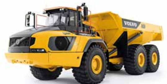
Basé sur la technologie Volvo éprouvée incluant la direction par articulation centrale, la transmission toutes roues motrices et les blocages de différentiel, le Volvo A60H est encore plus puissant et plus grand !
