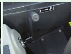
Accélérateur équipé d'un contacteur petite/grande vitesse de translation
