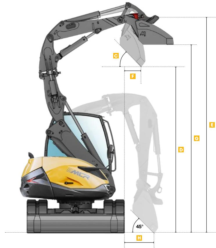
**CHARGEMENT ET DÉCHARGEMENT EN MODE CHARGEUSE À 45° ET 3 M DE HAUTEUR**
