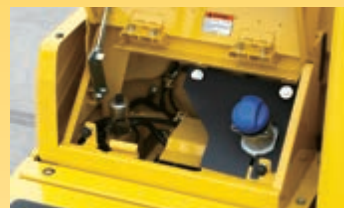
Pour faciliter l'accès au réservoir d'AdBlue®, celui-ci est installé sur l'escalier avant.
